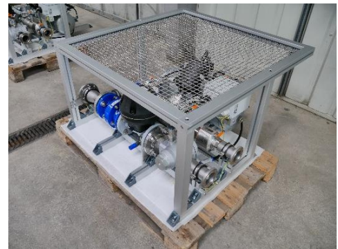
Abbildung 2: Stationäres Comprex®-Modul als Wandmodul im Einbauzustand mit Schutzgitter
