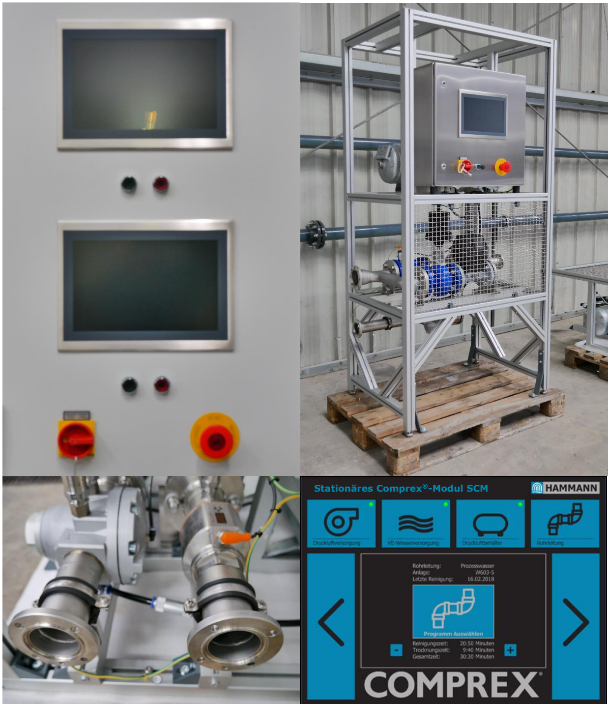
Abbildung 5: Weitere Ansichten des Stationären Complex®-Moduls (links oben: Kombi-Schaltschrank zur Steuerung von zwei Wandmodulen; rechts oben: Stand-Alone Ausführung; links unten: Flanschanschlüsse; rechts unten: Beispiel für Complex-Software)
