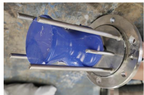
Abbildung 4: Molch mit Testfarbe nach der Comprex®-Reinigung
