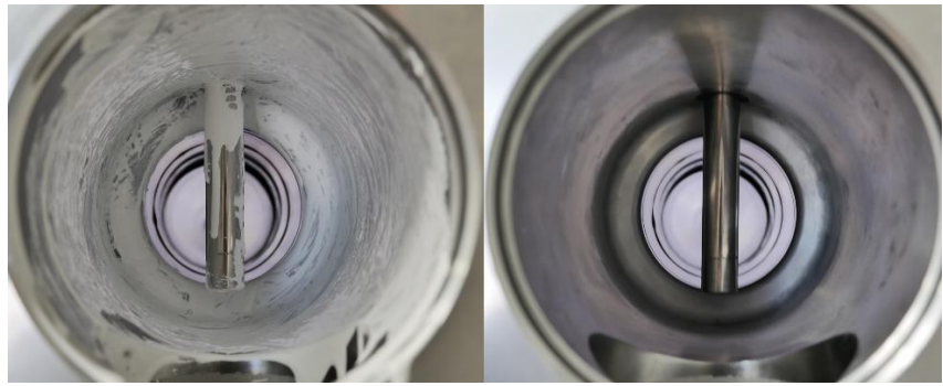
Abbildung 1: Molchschleuse mit Testfarbe vor und nach der Comprex®-Reinigung
