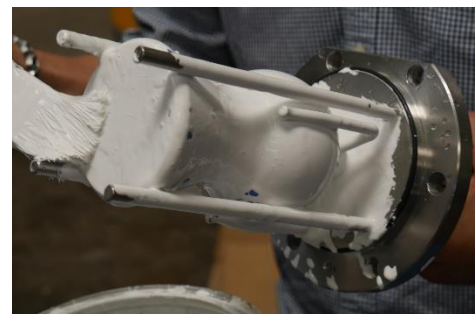
Abbildung 3: Molch mit Testfarbe vor der Comprex®-Reinigung
