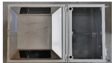
Abbildung 3: Ansicht von oben mit Dekomprimier- und Filtereinheit (links) sowie Pumpeneinheit (rechts)
