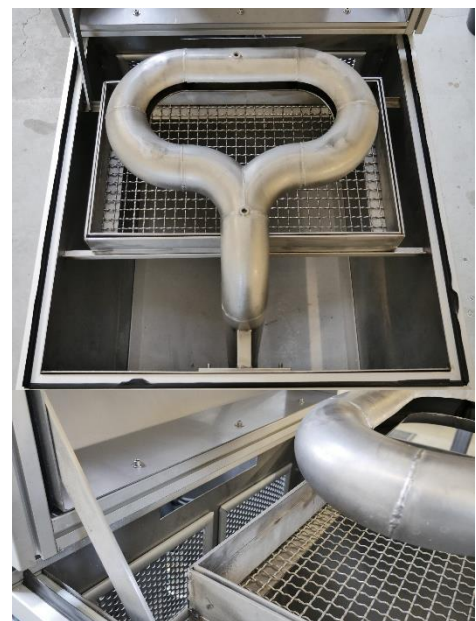
Abbildung 2: Dekomprimiereinheit mit Filtervlieshalter
