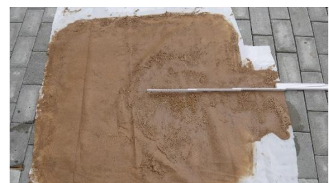
Abbildung 5: Schmutzaustrag auf Filtervlies
