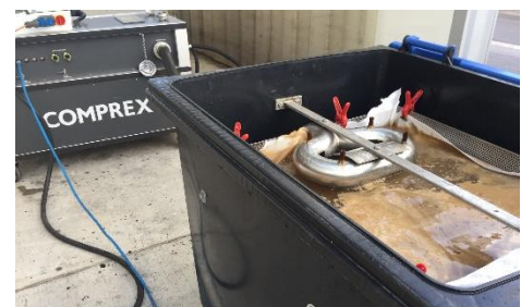
Abbildung 4: Filtervlies in Spülbox
