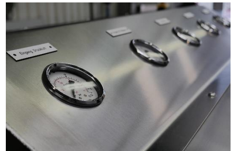
Abbildung 3: Manometer-Leiste mit allen relevanten Druckwerten
